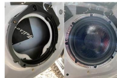
商品によっては鉄板を加工することなくスピーカーを取付可能。取付用のボルト、ナット、ワッシャー、ユニット固定用M4ボルトも付属ですぐに取り付け可能です。
