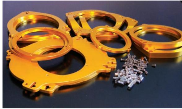
スピーカーの性能を100%引き出す性能と、ドア内部への浸水による腐敗等の影響を考慮し、高剛性の非磁性体、ジュラルミン系アルミで作った車種別インナーバッフルです。無垢材をCNCマニシングセンターでひとつひとつ削り、高精度に仕上げています。
