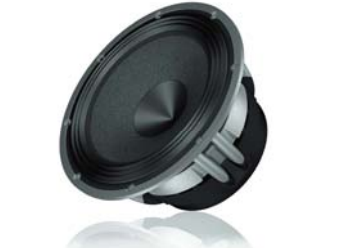
AV 10 本体価格 ¥48,000/本 ●再生周波数帯域:30~1kHz ●定格入力:400W ●入カインピーダンス:4Ω ●出力音圧レベル:91 dB/SPL ●取付口径サイズ:230mm ●取付奥行サイズ:138mm ●推奨BOX(シールド):12L~17L、(Vスレフ):16L~21L
