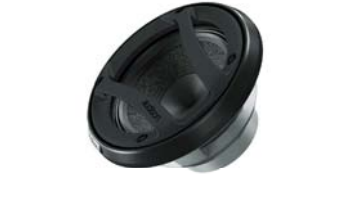
AV 3.0 本体価格 ¥20,000/ペア ●スピーカータイプ:MID WOOFER 70mm(3") ●再生周波数帯域:200~14kHz ●定格入力:50W ●入カインピーダンス:4Ω ●出力音圧レベル:93dB/Spl ●取付口径サイズ:73mm ●取付奥行サイズ:38mm ●グリル付属
